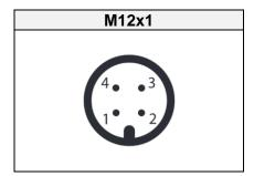
Pin 1 Versorgung UB+ Pin 2 Schaltausgang 2 Pin 3 Versorgung 0V Pin 4 Schaltausgang 1
